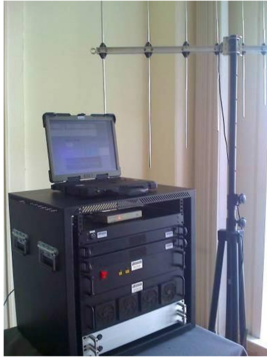
1.3. kép: Interjam zavaró állomás labormintája.[107]
