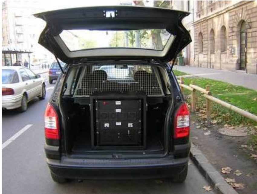
2.1. kép: Az INTERJAM eszköz labormintája gépjárműbe beépítve. [107] [163]
