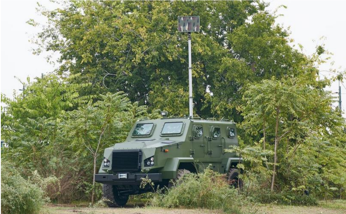
3.2. kép: RDO-3221 KOMONDOR jármű, tetején a Pro Patria Electronics Kft. által forgalmazott PGSR-3i 'Beagle' mozgócél felderítő radarral. [188]
