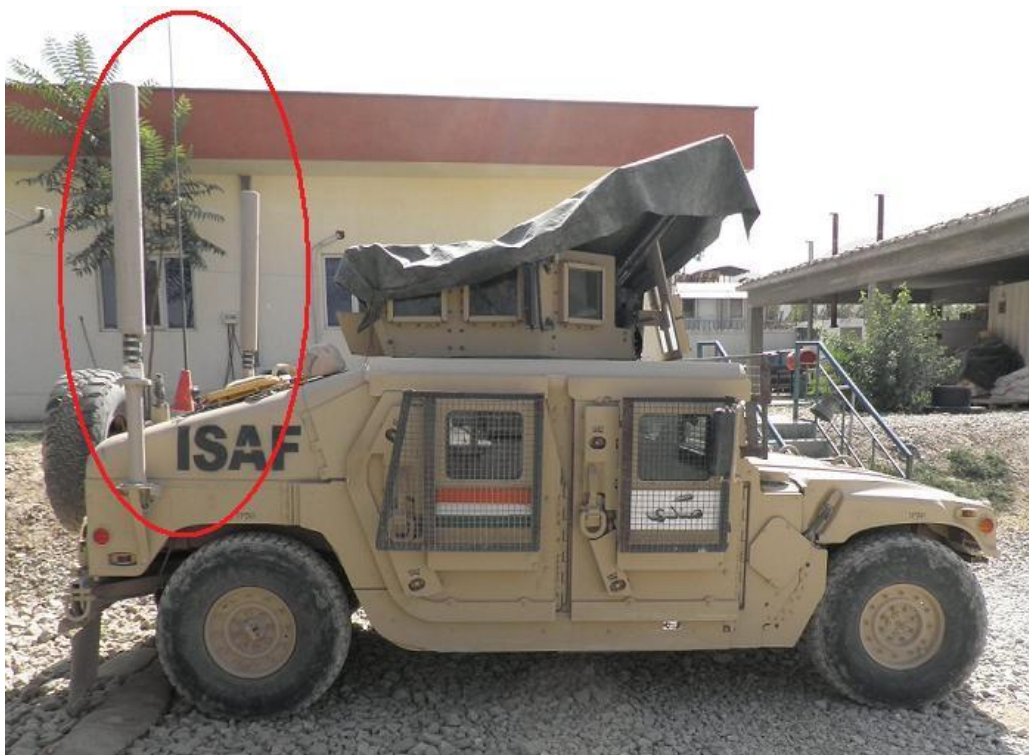
1.2. kép: Magyar jelzésű HMMWV 82 beépített elektronikai zavaróeszközének antennái az MH PRT 83 táborában. 84
