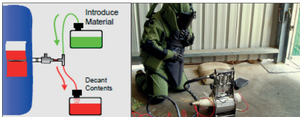
3. ábra: A robbanóeszköz veszélyes ABV-töltetének átfertése (forrás: Valent Applications Ltd., www.militarysystems-tech.com/suppliers/cbrn-eod-products/valent-applications-ltd )
