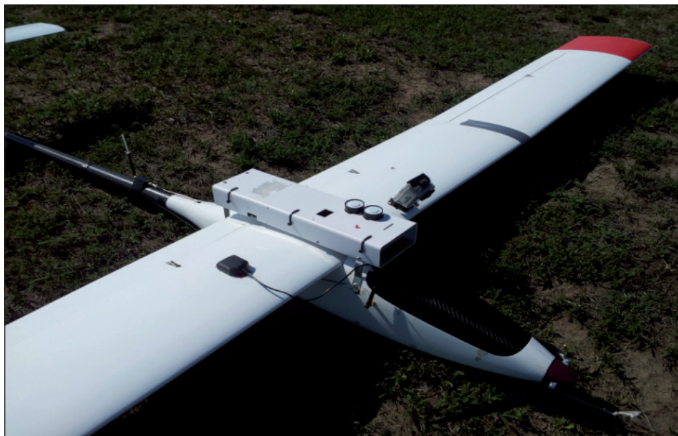
9. ábra: Különböző veszélyes anyagok mérésére alkalmassá tett PNR a fedélzetére installált szenzorokkal (forrás: Molnár, 2014)
