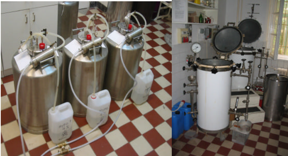
1.ábra: Mikroorganizmusok tömeges tenyésztésére szolgáló, sterilizeshető, levegőztethető egyszerű acél edények, ill. kiselejtezett, de működőképes kórházi sterilizáló készülékek (A szerző saját felvételei)
