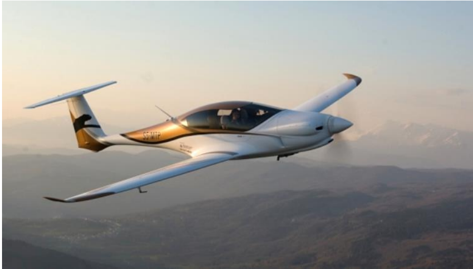
48. ábra. Hibrid hajtású Pipistrel, Panthera típusú repülőgépe [119.]
