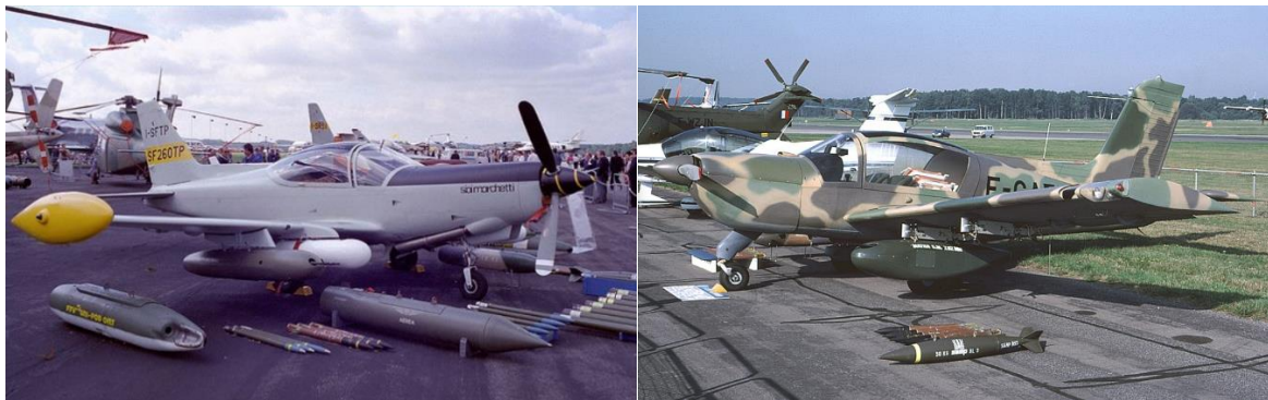
2. ábra. Az olasz Marchetti SF-260C és a francia Socata Rallye 235 felfegyverzési lehetőségei [40.],[41.]
