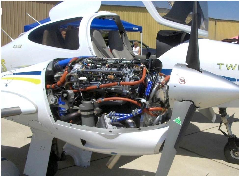
13. ábra. DA-42 könnyű repülőgépbe épített 1700 cm 3 lökettérfogatú dízelmotor [56.]
