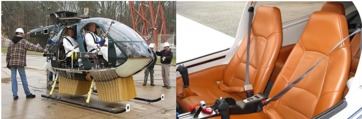
32. ábra. Az MD-500 külső és a Da-40 biztonsági övre szerelt légzsák rendszere [96.]
