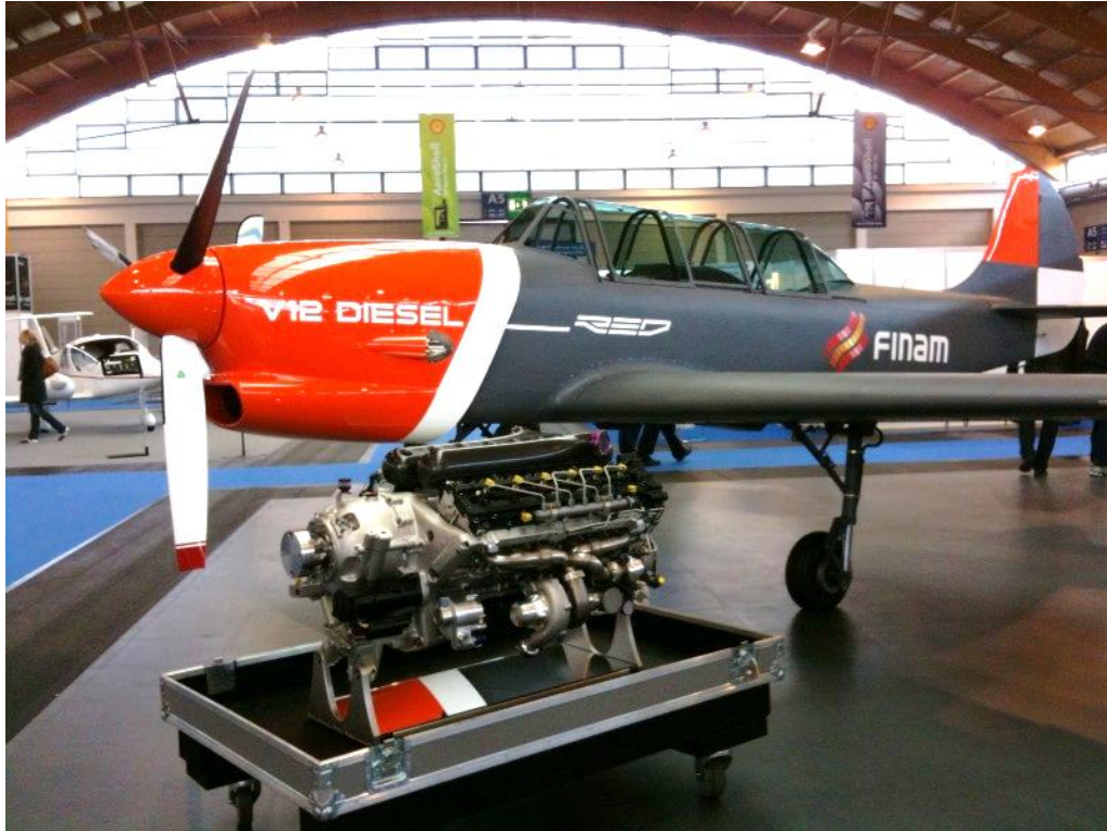
14. ábra. Audi eredetű Raikhlín RED-3 368 kW teljesítményű repülőgép dízelmotor egy Jak-52 típusú repülőgépbe építve [65.]
