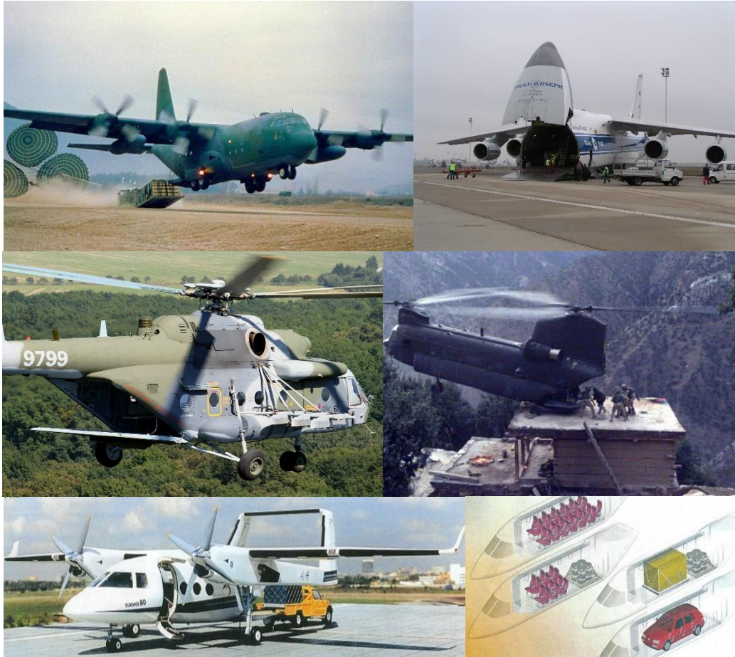
27. ábra. C-130, An-124, Mi-171, CH-47, Szu-80 rámpa-megoldásai [41.]
