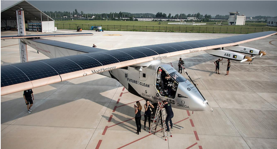
47. ábra. A napelemes töltésű, tisztán elektromos hajtású Solar Impulse 2 [118.]
