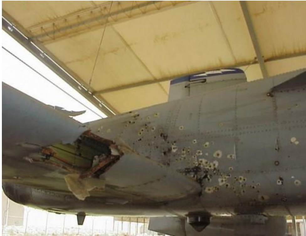
25. ábra. Bevetésben sérült A-10 Thunderbolt repülőgép [79.]
