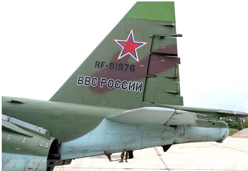
26. ábra. A Szu-25 függőleges vezérsík és oldalkormány konstrukciója [41.]
