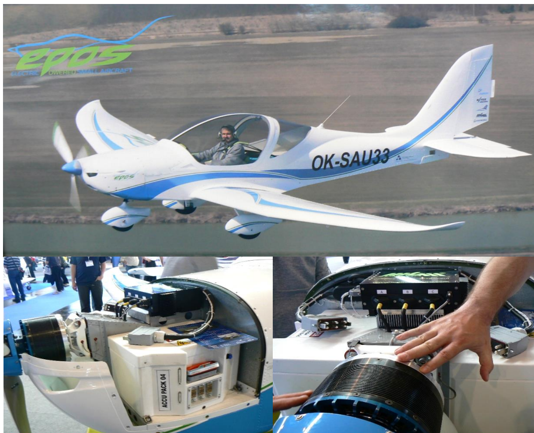
43.ábra. Epos, tisztán elektromos hajtású repülőgép 1 óra repülési idővel [Hennel Sándor őrnagy saját gyűjteménye]
