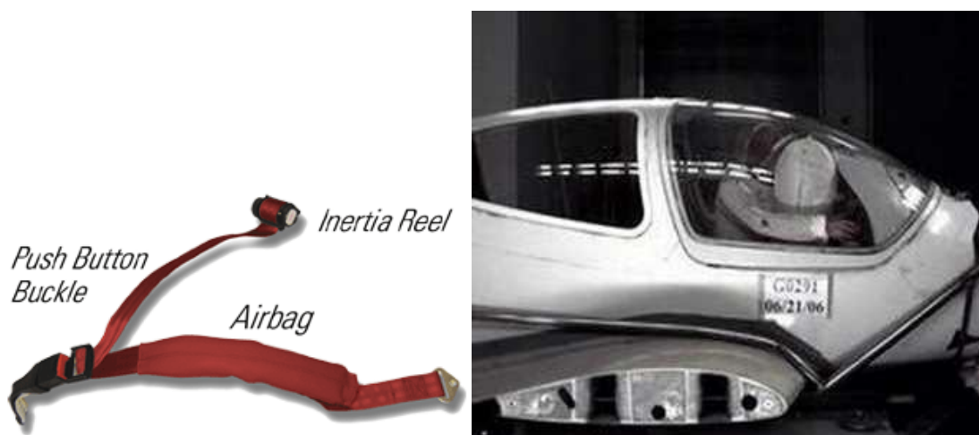
31. ábra. A Mooney légszak és a vele szerelt Diamond Da-40 típusú repülőgép törési tesztje [94.],[95.]
