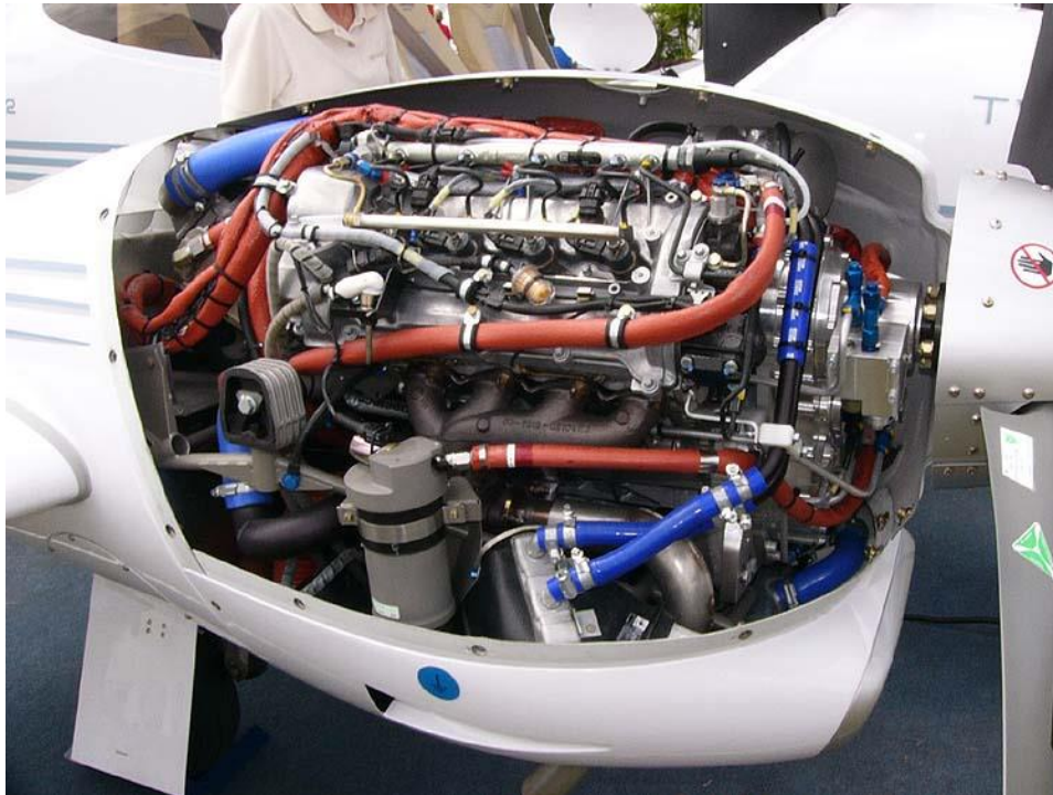
40. ábra. Diamond DA-42-be épített Thielert Centurion 1.7 dízelmotor [108.]
