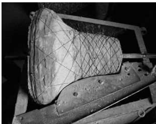
2. kép: Az álharang formázásának kezdete
